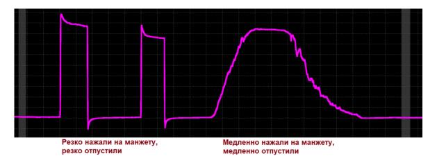
Всё рисуется согласно пояснения: "всплеск" и "провал" – это не из-за того, что под эти "всплеск" и "провал" дополнительно изменяется объем манжеты. Это искажение, которое вносится в изображение сердечного цикла за счет проявления инерционных свойств воздуха при оказании на поверхность манжеты быстрого пульсирующего воздействия. Как снаружи манжеты, так и изнутри, то есть от пульсации артерии.
